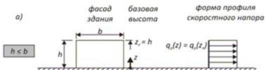
Рисунок 4.2 – Базовая высота z_e в зависимости от h и b и профиля скоростного напора
